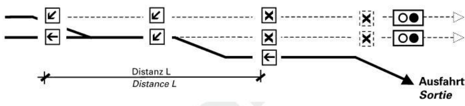
Figura 4: Disposizione FLS per chiusura corsia di sorpasso (carreggiata a due corsie)
